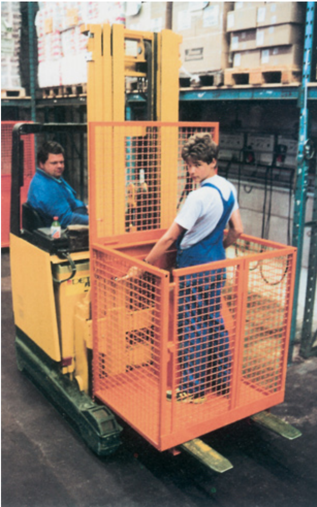
Arbeitsbühne mit ortsbindendem Zustimmungsschalter: Hub- und Fahrbewegungen können mit dieser Arbeitsbühne nur bei gleichzeitiger Betätigung der Zweihand-Zustimmungstaster ausgeführt werden.
